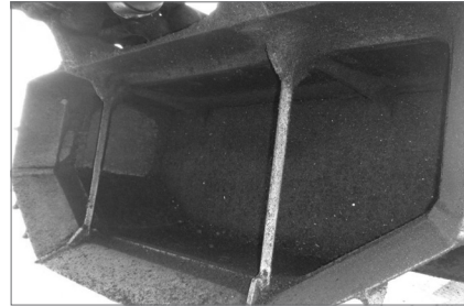
현장 설치에 따른 시범 설치 버킷
