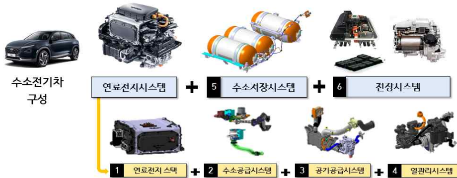
[그림 2-5] 수소차 핵심모듈(시스템) 형태
