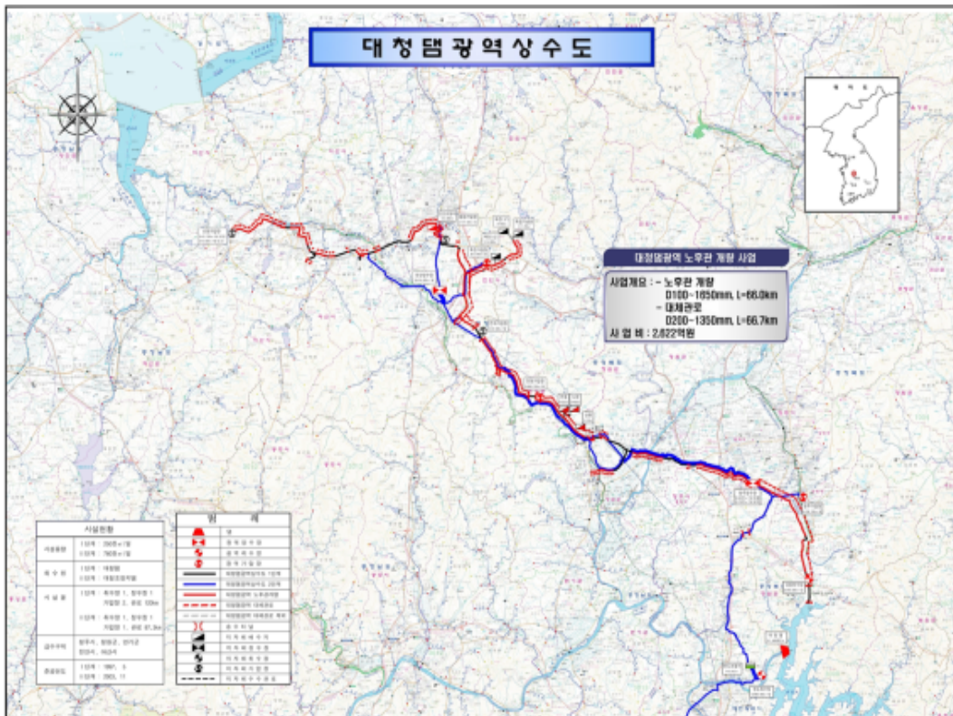
[그림 1] 대청댐 광역상수도 노후관 개량사업 계획 평면도
