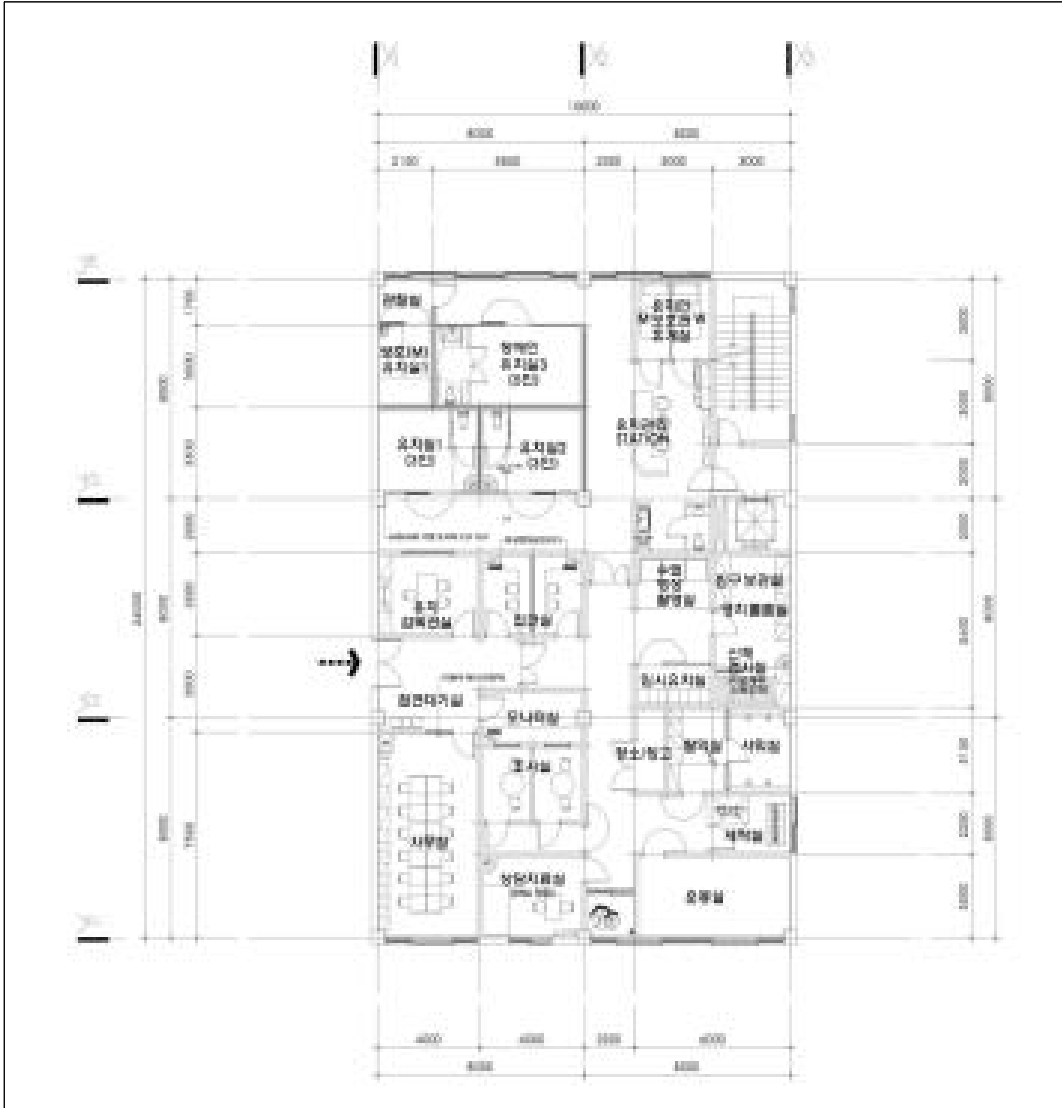
[그림 III-12] 일반유치장 평면도(면적: 24m×16m)
