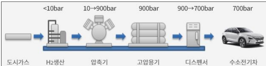
[그림 III-23] 배관으로 공급되는 연료를 개질하여 수소를 생산하는 수소 충전소 구성 예시
