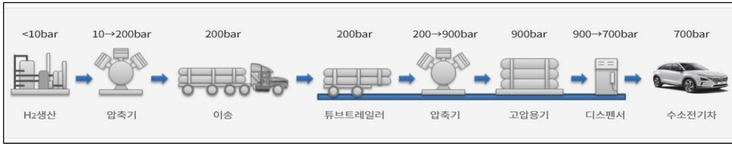
[그림 III-21] 튜브트레일러로 수소를 공급하는 수소 충전소 구성 예시
