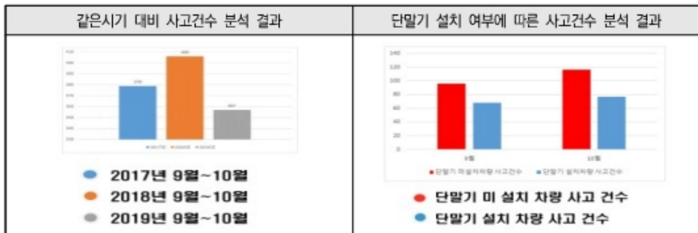
[그림 VIII-11] C-ITS 단말기 장착 전후 사고 건수 분석
