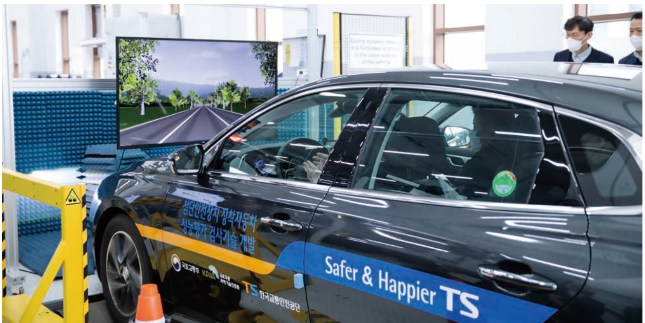
첨단 안전장치(ADAS)를 장착한 자동차의 성능 평가를 위한 검사 기술 개발 모습(사진출처: 저자)
