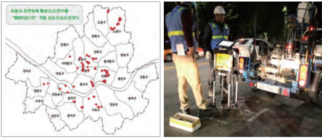
도심 싱크홀 예방조사에 광해방지 신기술을 활용한 지역 및 서울시 동대문구의 지하 공동 측정 장면
